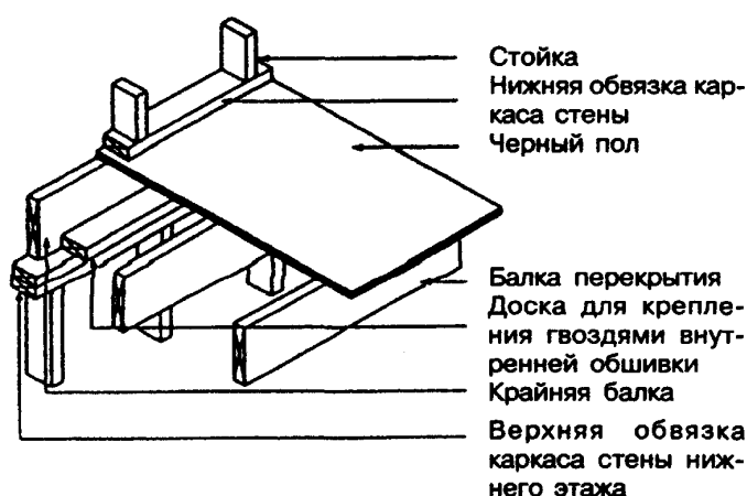
Рисунок 7-4 — Деталь установки доски для крепления внутренней обшивки
