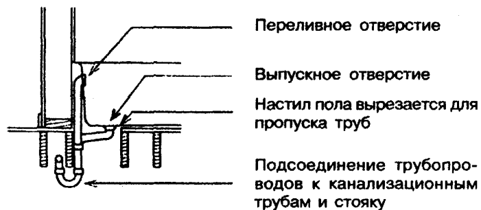
Рисунок 13-6 — Детали установки умывальника и ванны
