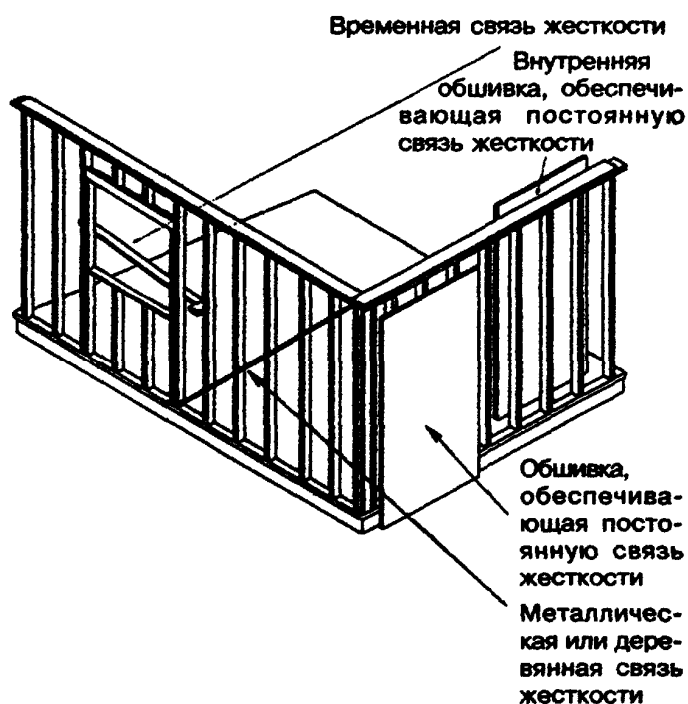
Рисунок 7-1 — Каркас стены
